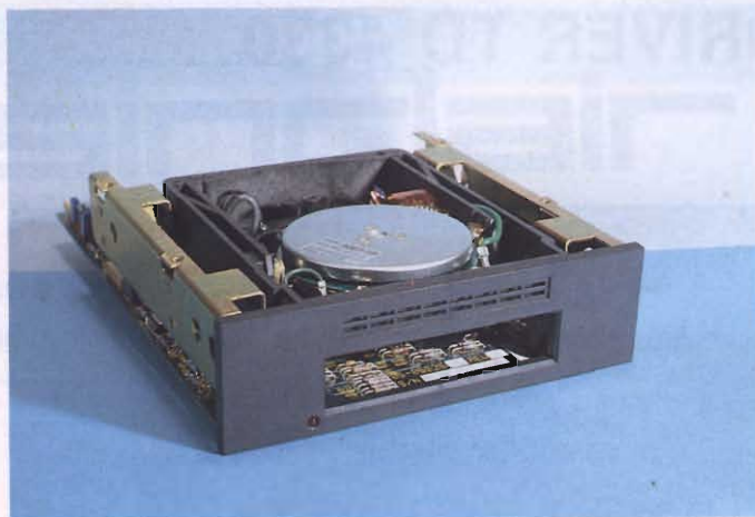
La parte frontale del Tape Drive TD4330 offre un vano per l'alloggiamento delle cartucce.
