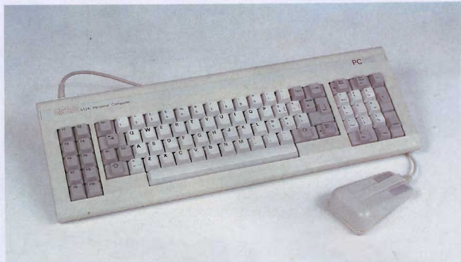
Primo piano della tastiera data in dotazione al PC1512. Si notino i due tasti speciali di cancellazione destra e sinistra.
