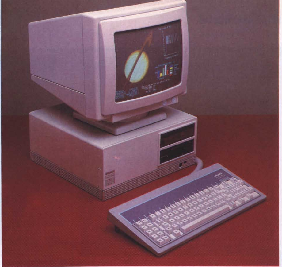
Il Personal Engineering P.E. M 24 della Olivetti con Hard Disk da 20 Mbyte ed il coprocessore 8087 di serie.
