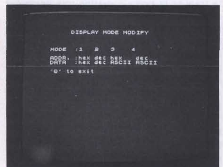
La visualizzazione dei dati e degli indirizzi di memoria può avvenire in 4 modi diversi: hex/hex, dec/dec, hex/ASCII oppure dec/ASCII.
