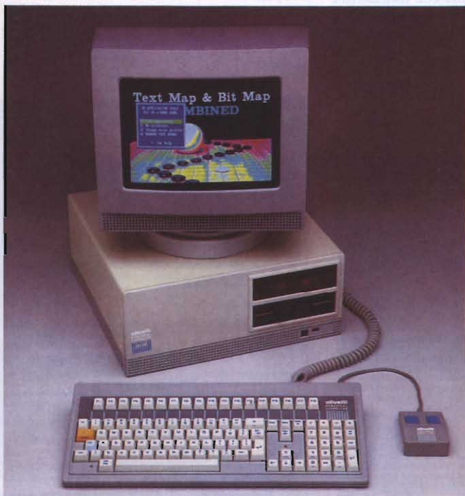
Sempre Olivetti è questo M24 SP con Hard Disk da 20 Mbyte e clock a 10 MHz.
