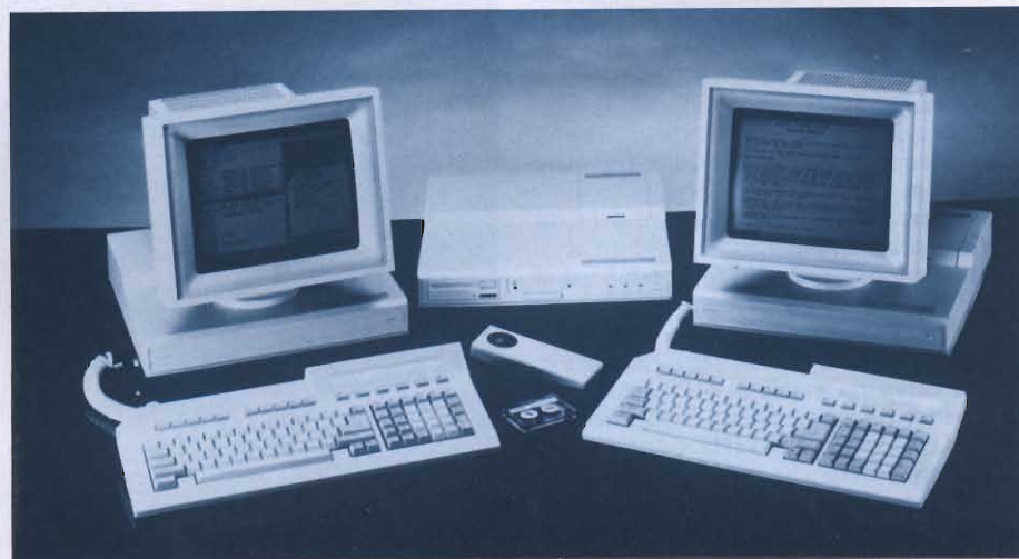
Sempre dell'Apricot lo XEN MULTIUSER composto da un mainframe XEN 20 al centro con due Workstation dotate del monitor Paperwhite.
