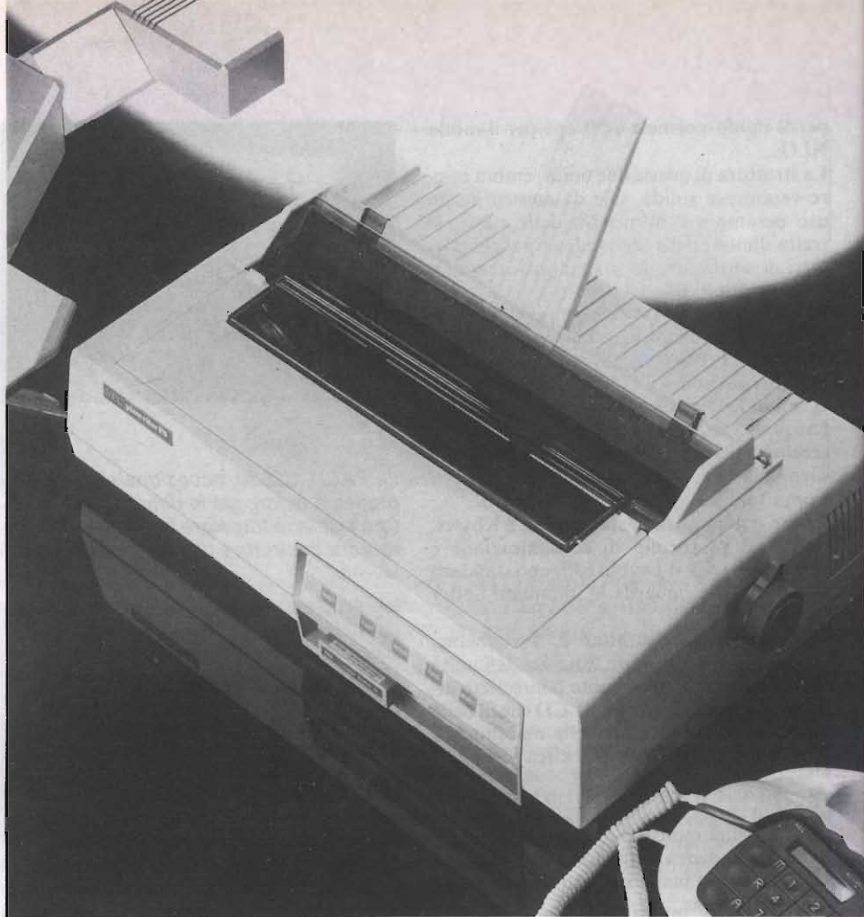
La NEC PinWriter P5: è visibile, in basso a destra, una cartuccia ROM inserita nel suo slot.
