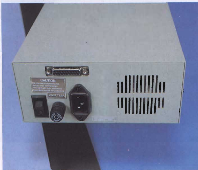
Particolare del retro del SH204 dove si trovano la presa di collegamento al computer e blocco relativo all'alimentazione.
