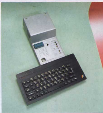
Ecco come si presenta l'SP85 collegato al retro dello Spectrum tramite la presa a pettine.
